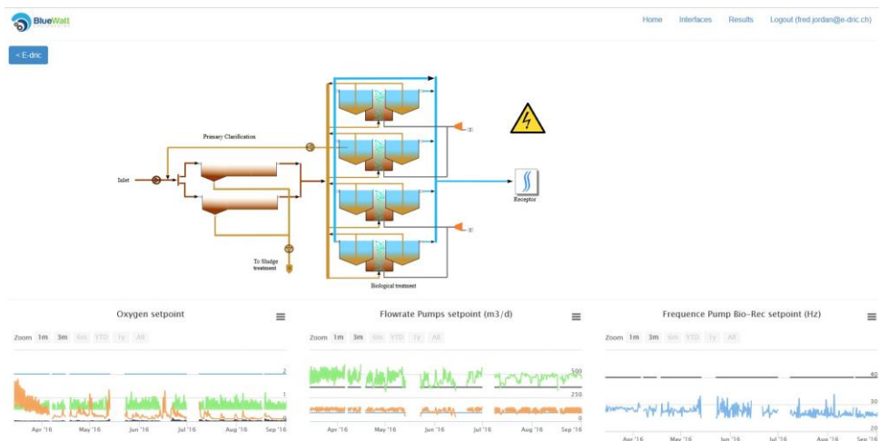
Figure 3: Exemple de modélisation en temps réel / prévisionnel de la STEP de l'ERM
